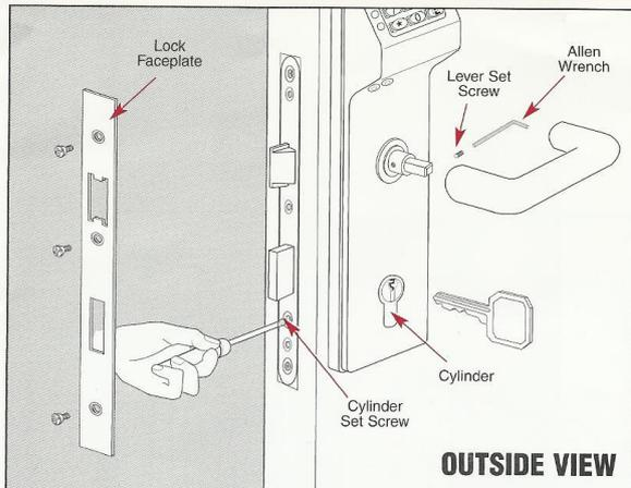
**BEFORE CLOSING DOOR TEST LOCK FOR PROPER OPERATION**
